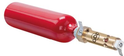
Es gibt eine Variante, die über eine permanente Druckanzeige in Form eines werkseitig eingebauten und leckgeprüften Manometers verfügt. Dieses zeigt den Innendruck der Kartusche an. Der Nennbereich (grün markiert) für den Innendruck liegt bei etwa 34bar (T=20°C). Diese Variante ist für die Sichtkontrolle durch den Benutzer der AMFE-Löschanlage, direkt an der Löscheinheit.
