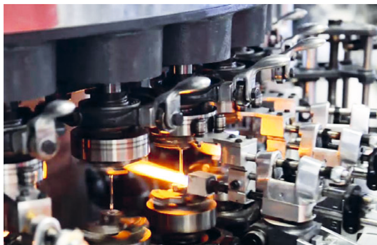
Mit der Rohglasformgebungsmaschine werden die Glasampullen geformt
