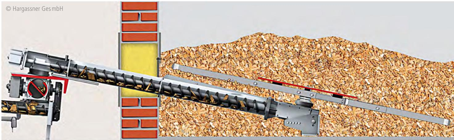
Abb. 4: Einschub des Brennstoffes in die Brennkammer mittels Einschubschnecke
