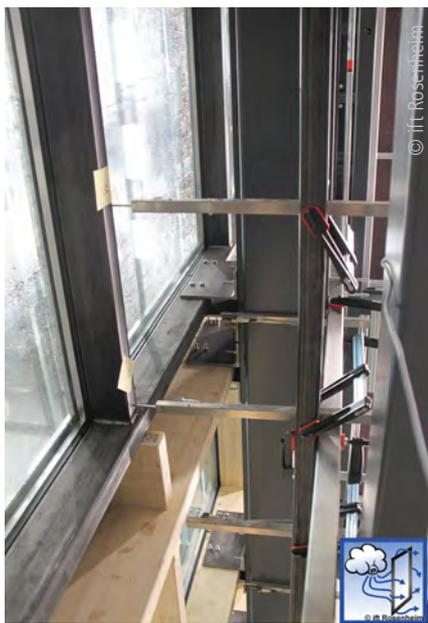
Fassadenprüfung im ift Rosenheim mit Windbelastung, bei der neben der Durchbiegung auch die Luftdurchlässigkeit bei Windsog nach DIN EN 12153 ermittelt werden muss
