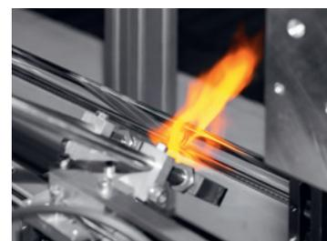
Auch die Glasfertigung für die Produktion von Thermo-Bulbs erfolgt intern
